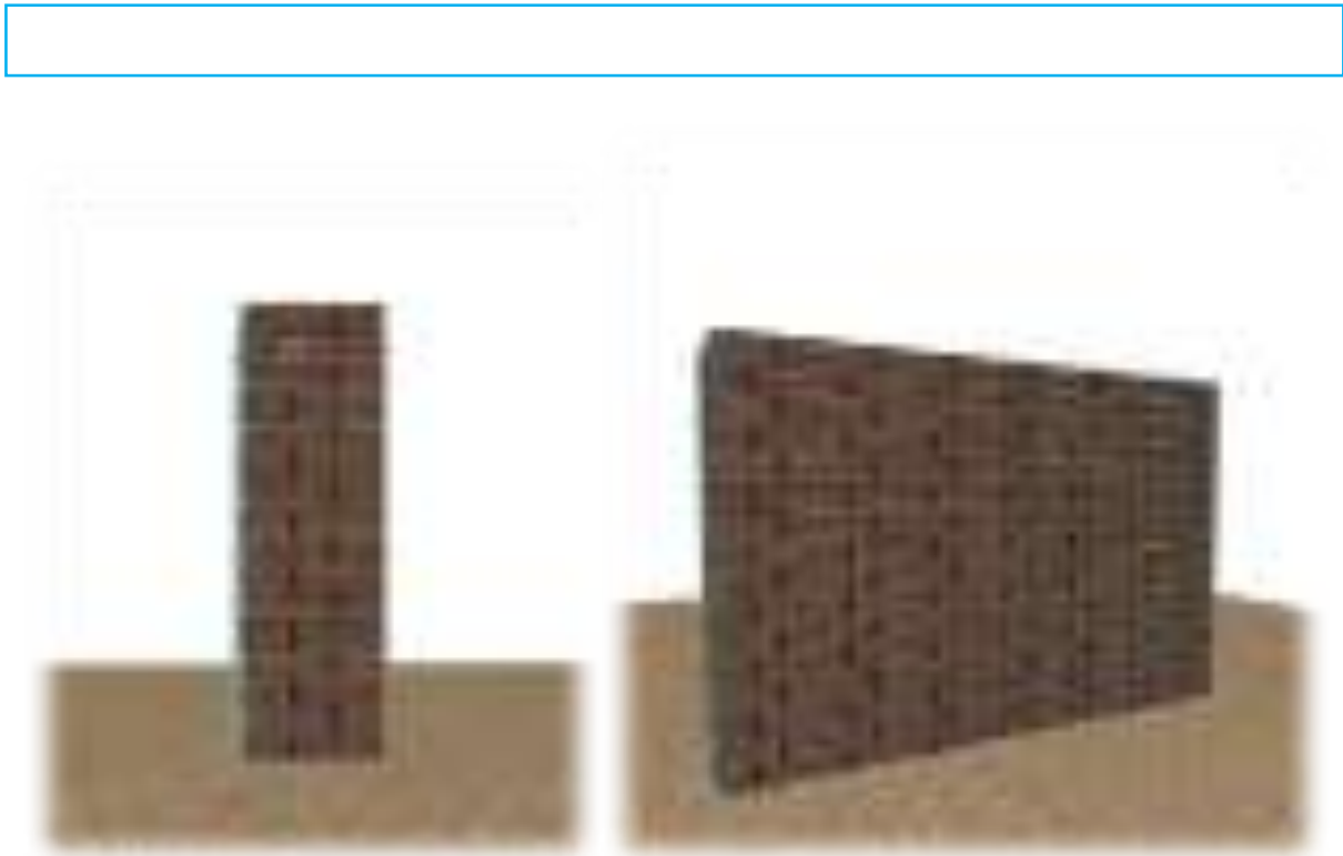
Figure 23: Appareillage du mur porteur
