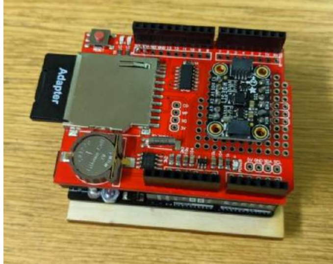
FIGURE 10 – Arduino Uno et son shield carte SD avec l'accéléromètre soudé
