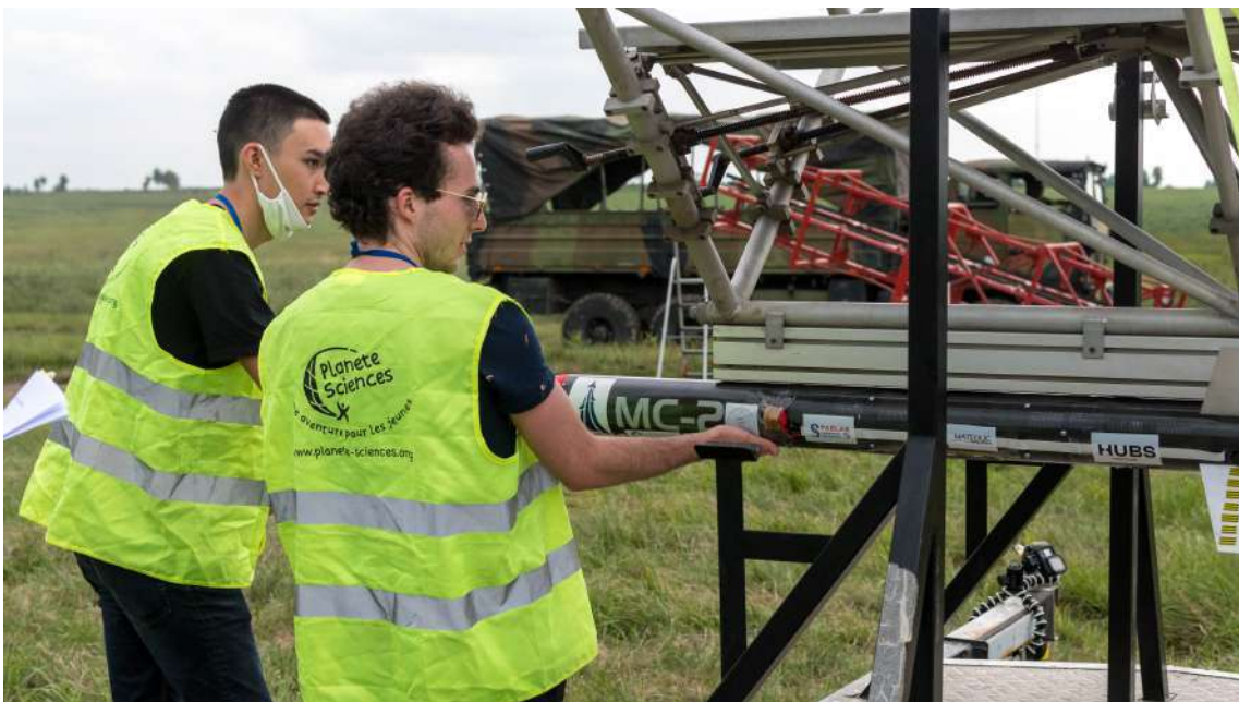
FIGURE 16 – Mise en rampe de la fusée
